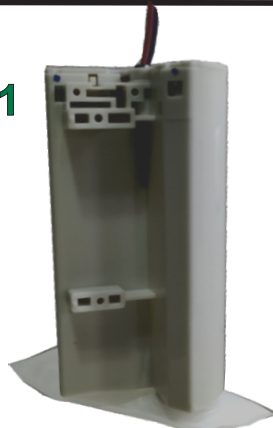
Bomba de Gasolina Ford 350 Modulo
